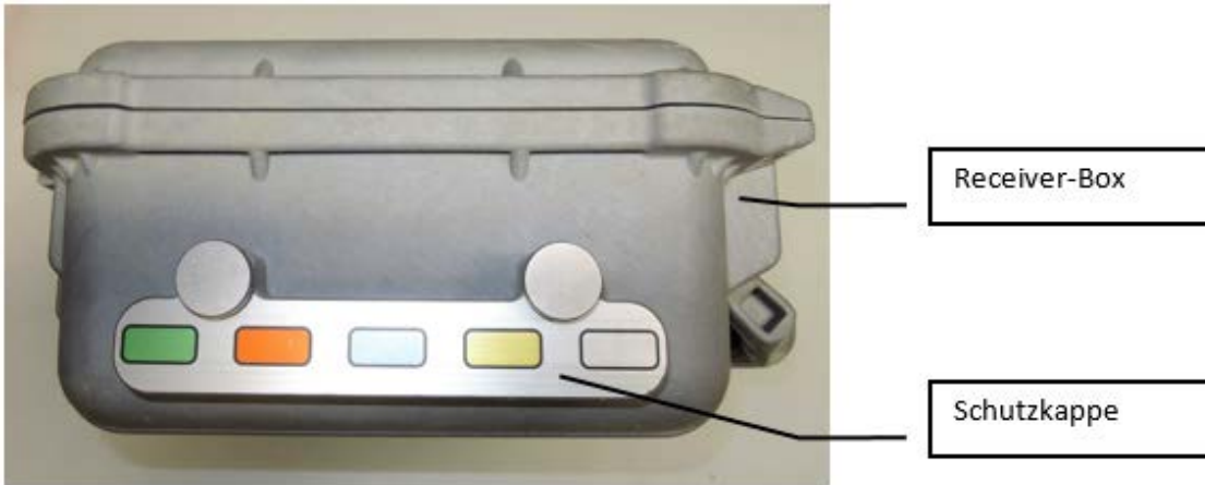
Abb. 9: Schutzkappe auf den Anschlüssen der Receiver-Box
