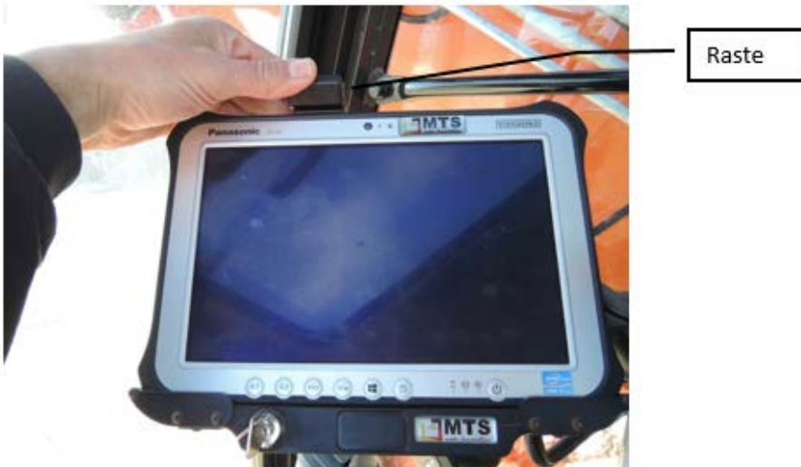
Abb. 4: Tablett-PC in den Halter einsetzen
