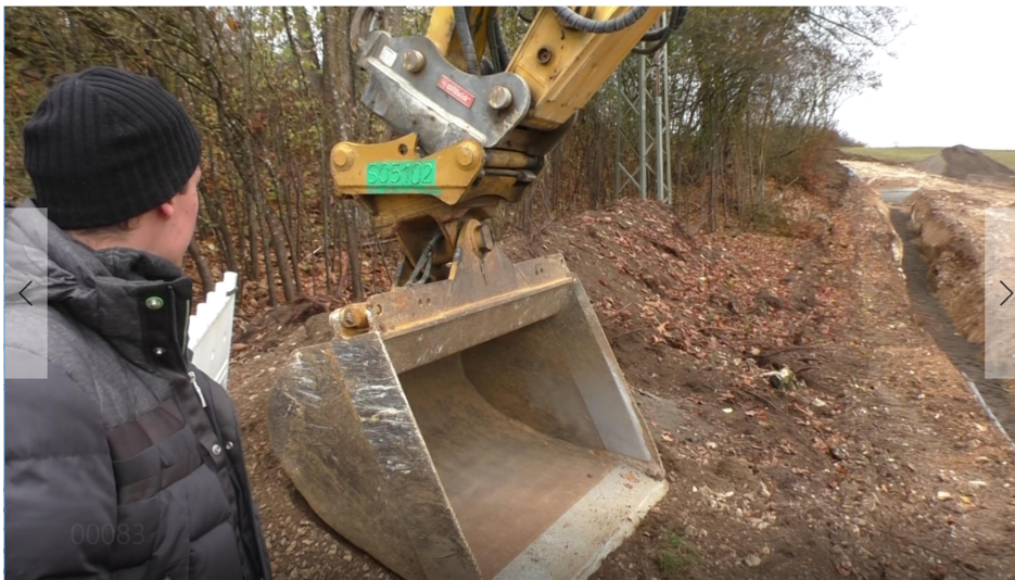
Abb.: 2: Aufnahme des neuen Schwenklöffels. Zu sehen ist das Schnellwechselsystem OQ 70-55, darunter die Wechseinheit mit der Schwenkachse und dem Schwenklöffel.
