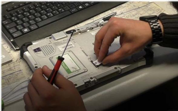
**Warnung:** Es ist verboten Zangen oder ähnliches Werkzeug zum Herausziehen der SIM-Karte zu verwenden! Der Slot kann dadurch beschädigt werden!
