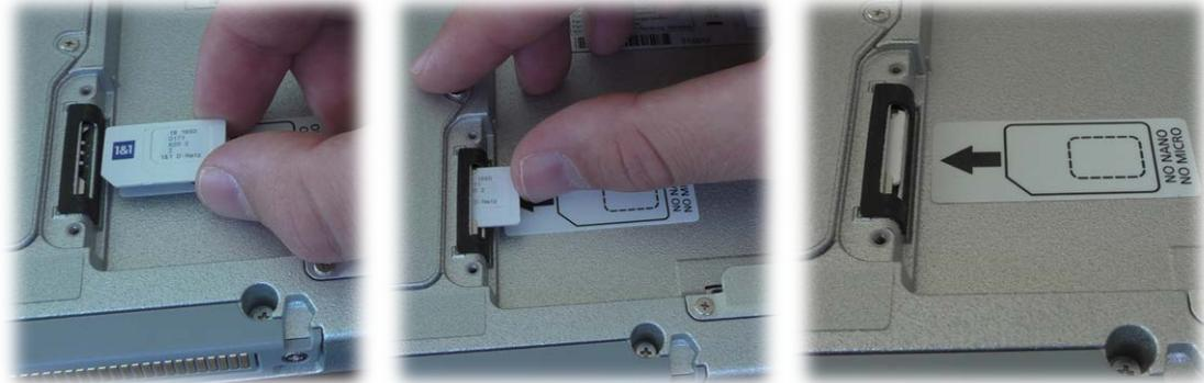
**Warnung:** Achten Sie beim Einlegen der SIM-Karte darauf, dass die goldfarbene Kontaktfläche auf die Unterseite zeigt und die Seite mit dem fehlenden Eck in den SIM-Kartenschacht hinein zeigt.
