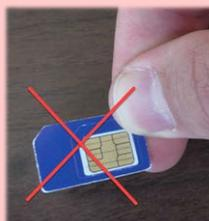
*Warnung: Die Innenteile der SIM-Karte (für Mikro- und Nano-SIM) dürfen nicht herausgebrochen werden und dürfen auch nicht als SIM-Karten im SIM-Slot verwendet werden!*
