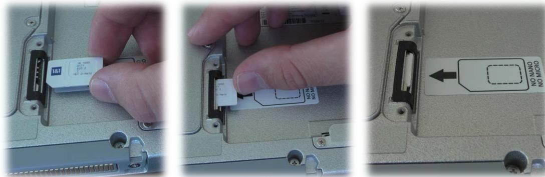
*Warnung: Achten Sie beim Einlegen der SIM-Karte darauf, dass die goldfarbene Kontaktfläche auf die Unterseite zeigt und die Seite mit dem fehlenden Eck in den SIM-Kartenschacht hinein zeigt.*
