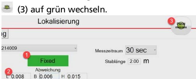
Der Schalter Messung befindet sich rechts oben am Bildschirmrand. Sie können so das Toughpad mit der rechten Hand sicher umklammern und mit dem Daumen den Messschalter drücken, bzw. die Messung auslösen!
