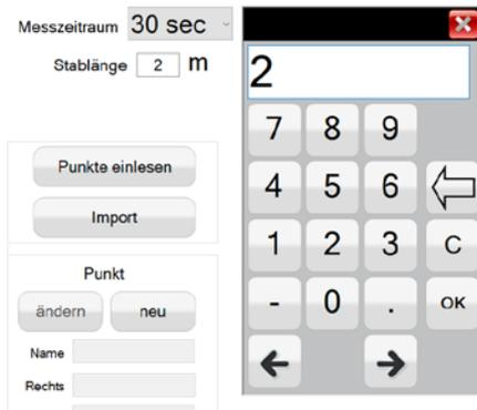
Wenn Sie dagegen z.B. mit dem MTS-Rucksack-Rover arbeiten, dann ändert sich die Stablänge, da das Messzentrum anders berechnet wird. Sie müssen dann die Antennenlänge plus 6 cm berücksichtigen. In diesem Falle wäre die Stablänge 2,06 m.
