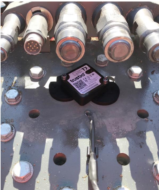
Abbildung 26: Befestigung eines Trackers mit Hilfe von Magneten
