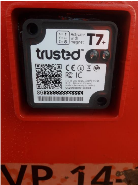
Abbildung 25: Befestigung eines Trackers mit Industriekleber und Schutzrahmen
