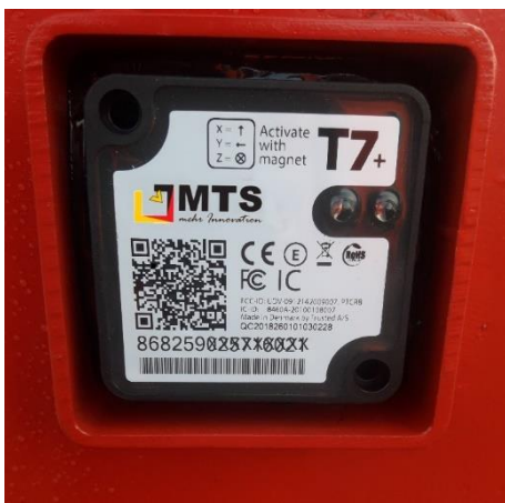
Abb. 2: Befestigung eines Trackers mit Industriekleber und Schutzrahmen
