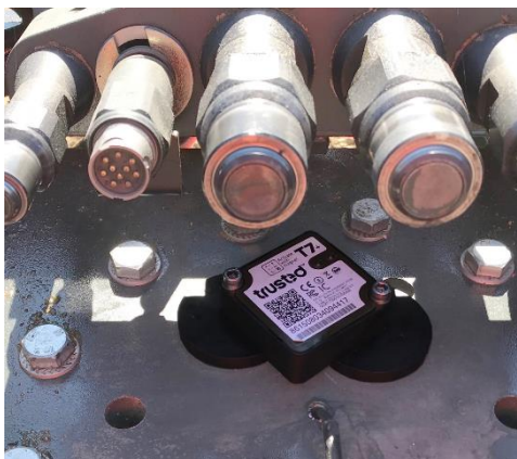
Abb. 3: Befestigung eines Trackers mit Magnethalterung
