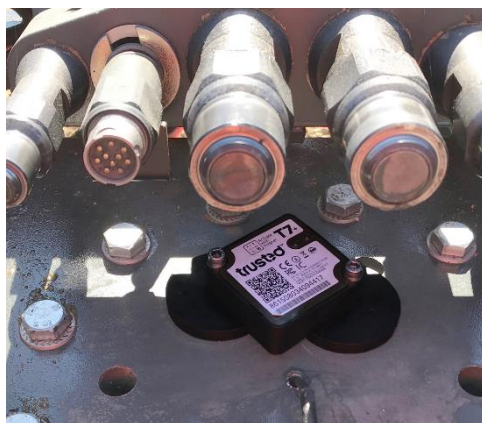
Abb. 3: Befestigung eines Trackers mit Magnethalterung
