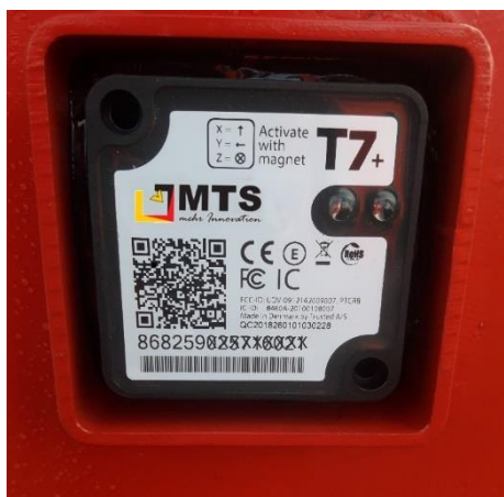
Abb. 2: Befestigung eines Trackers mit Industriekleber und Schutzrahmen
