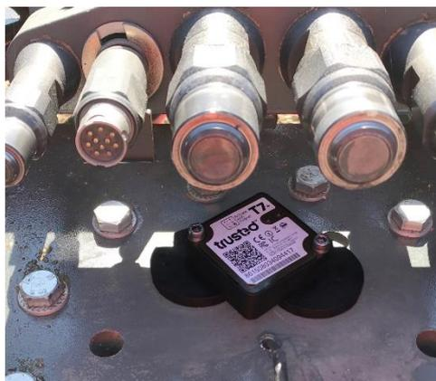
Abb. 3: Befestigung eines Trackers mit Magnethalterung
