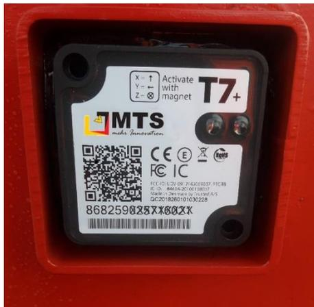
Abb. 2: Befestigung eines Trackers mit Industriekleber und Schutzrahmen
