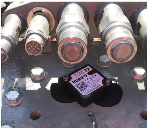
Abb. 3: Befestigung eines Trackers mit Magnethalterung
