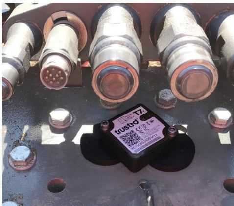
Abb. 3: Befestigung eines Trackers mit Magnethalterung
