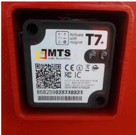
Abb. 2: Befestigung eines Trackers mit Industriekleber und Schutzrahmen
