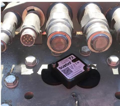
Abb. 3: Befestigung eines Trackers mit Magnethalterung
