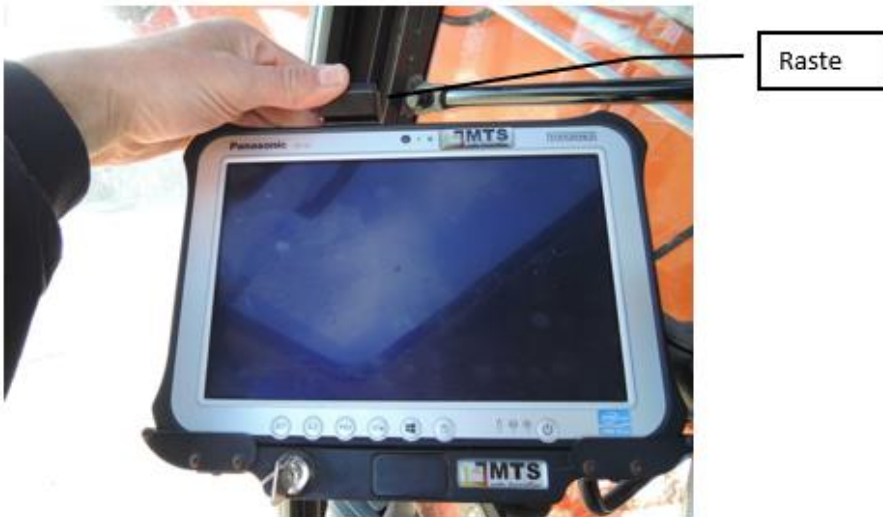
Abb. 4: Tablett-PC in den Halter einsetzen
