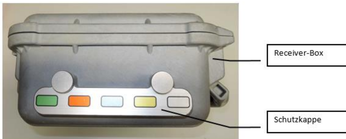
Abb. 9: Schutzkappe auf den Anschlüssen der Receiver-Box
