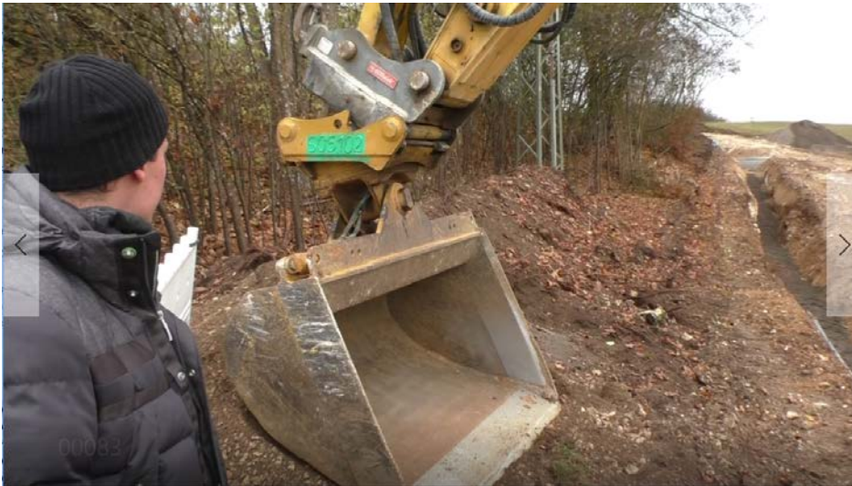
Abb.: 2: Aufnahme des neuen Schwenklöffels. Zu sehen ist das Schnellwechselsystem OQ 70-55, darunter die Wechseleinheit mit der Schwenkachse und dem Schwenklöffel.
