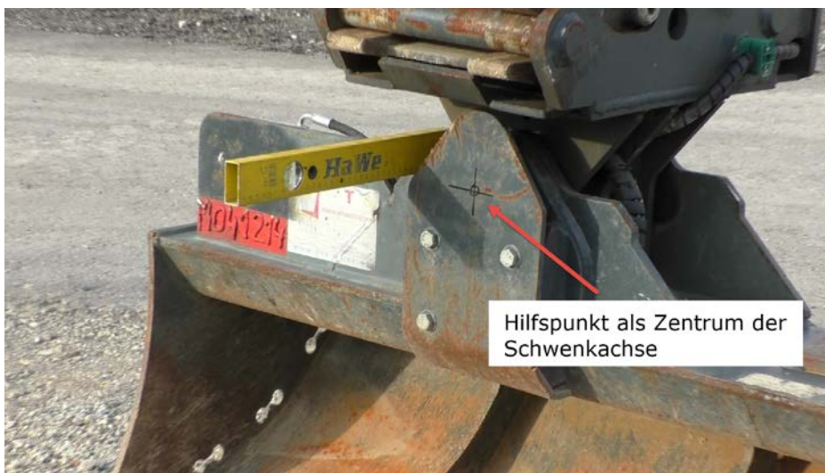
Abb.: 6: Falls das Zentrum der Schwenkachse nicht erkennbar ist, müssen Sie einen Hilfspunkt konstruieren und mit einem Markierstift deutlich kennzeichnen.
