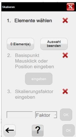
Zeichnungselemente werden von einem Basispunkt (P1) und einem Skalierungsfaktor in der Größe geändert.
