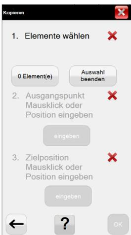
Zeichnungselemente werden von einem Ausgangspunkt (P1) zu einem Zielpunkt (P2) kopiert. Dies kann graphisch durch Klicken in die Zeichnung oder durch Koordinateneingabe erfolgen.
