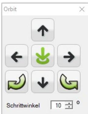
Mithilfe des Navigationspanels können Sie die planare und räumliche Drehung schrittweise in definierte Richtungen drehen, was bei komplexen Modellen oft hilfreich ist.
