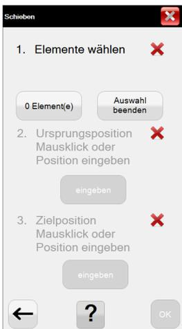
Zeichnungselemente werden von einem Ausgangspunkt (P1) zu einem Zielpunkt (P2) verschoben. Dies kann graphisch durch Klicken in die Zeichnung oder durch Koordinateneingabe erfolgen.
