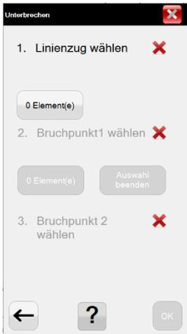
Eine Linie wird zwischen zwei Punkten unterbrochen. Dazu wird zunächst die Linie ausgewählt, danach die beiden Bruchpunkte gesetzt.
