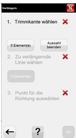
Zeichnungselemente werden mit einer oder mehreren Linien verlängert. Dazu wird zunächst die Trimmkante ausgewählt, danach die zu verlängernde(n) Linie(n).
