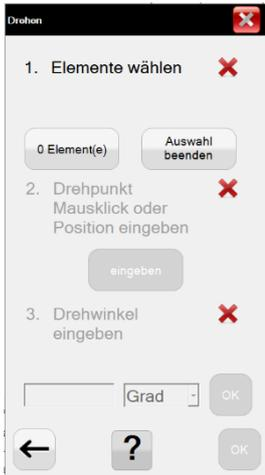
Zeichnungselemente werden um einen Drehpunkt (P1) und einem Drehwinkel (in Grad) gegen den Uhrzeigersinn gedreht. Dies kann graphisch durch Klicken in der Zeichnung oder Gradeingabe erfolgen.
