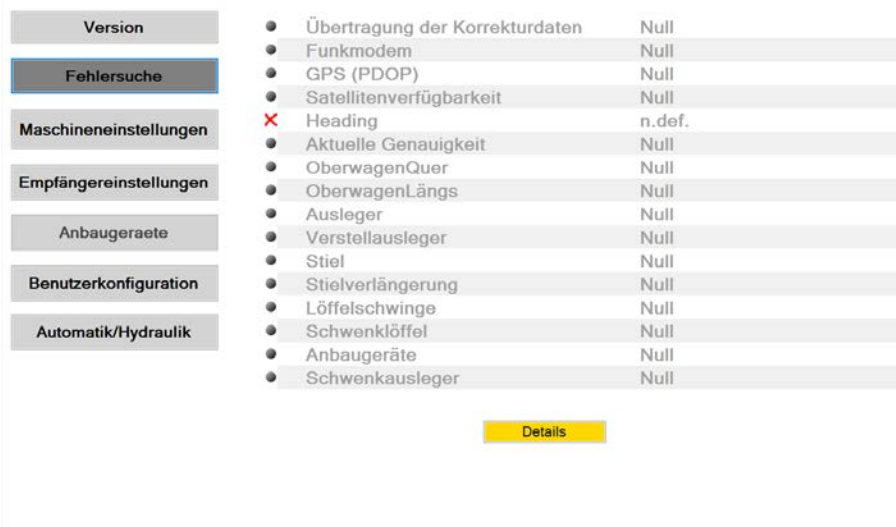
Abb. 13: Über die nebenstehend abgebildeten Schalter können verschiedene, von der Firma MTS - Maschinentechnik Schrode AG vorkonfigurierten Systemparameter wie z.B. Einstellungen für den aktuellen Bagger, das gewählte Anbaugerät und weitere Konfigurationsparameter angezeigt werden.
