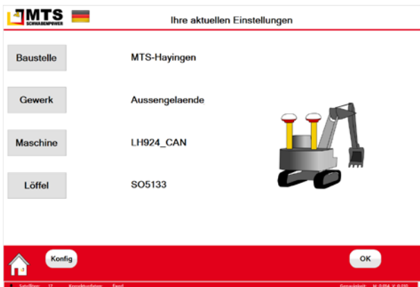
Abb. 7: Konfigurationsdialog mit einem Beispiel einer Baustelleneinrichtung und den verwendeten Maschinen.
