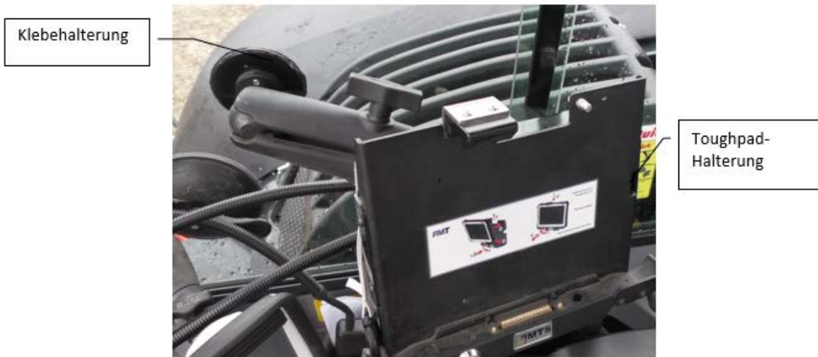
Abb. 2: Halter mit Klebevorrichtung in das Führerhaus einbauen
