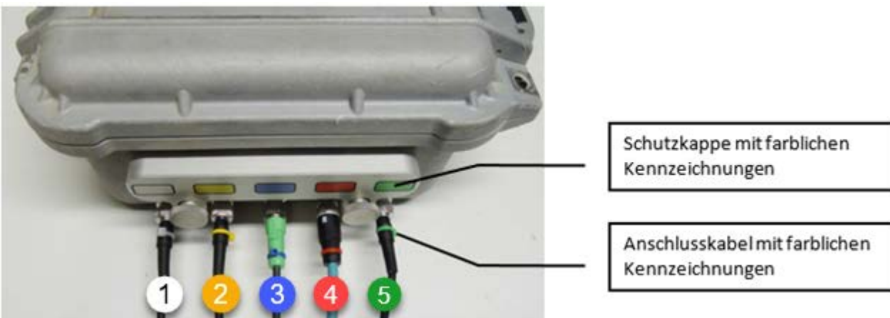
Abb. 11: Anschlusskabel an die Receiver-Box anschließen
