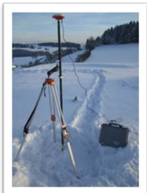
Abb. 5: Beispiel für den kurzzeitigen Aufbau einer Basis mithilfe einer Roverstange, Dreibeins und Klemme.
